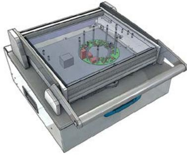
3D-Konstruktion eines Testadapters
