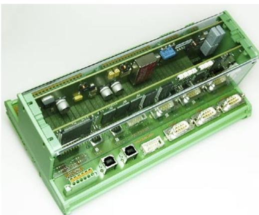
Zu diesem Zweck sind die Fahrzeuge des ÖPNV mit Funkgeräten ausgerüstet, die vor dem Erreichen der Lichtsignalanlage eine Anmeldung ermöglichen. Das ÖPNV-Modul wertet diese Signale aus und gibt die Information an das Steuergerät der Lichtsignalanlage weiter.
