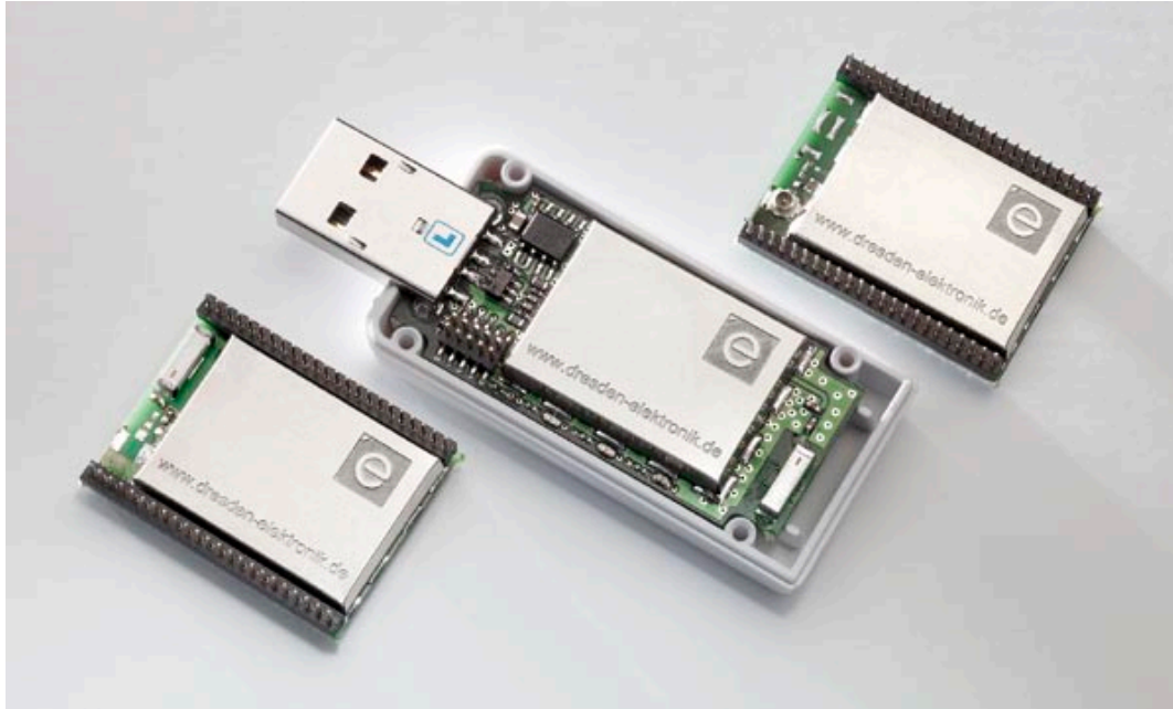
Funkmodule und USB Funk-Sticks auf Basis des ATmega128RFA1
