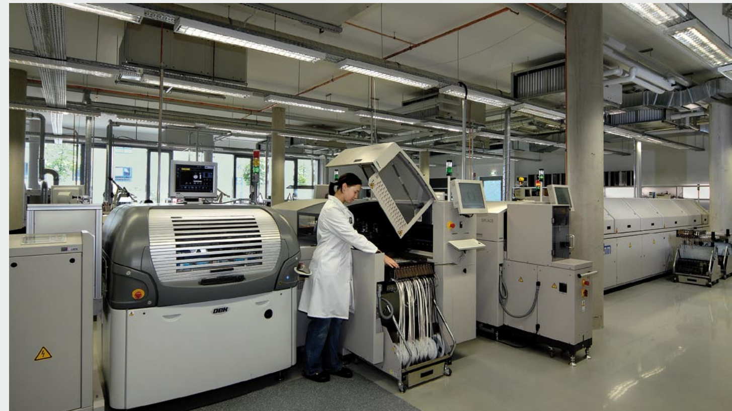
Bestückungslinie mit DEK-Drucker, Siemens-Bestückern und Rehm-Reflowöfen
